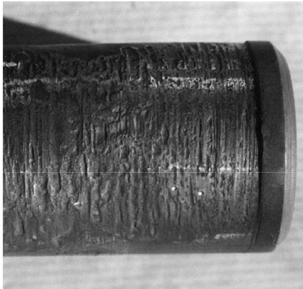
Figure 5 - Usure abrasive à trois corps : arbre en acier nitruré frottant sur coussinet en acier 100 Cr 6, en ambiance d'eau chargée de sable
